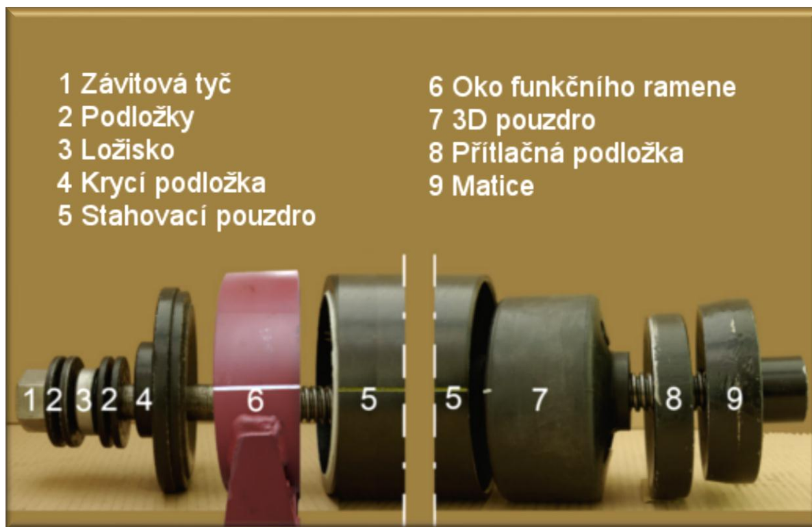
Obr. 7: Přehled montážního nástroje (pro lepší ilustraci zobrazen deformovaně)
